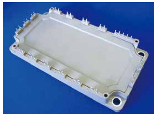
Si-IGBT -SiC-SBDハイブリッドモジュール
