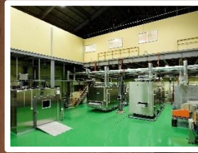
「テストルーム」 急速凍結装置や、解凍設備 を設置。テスト検証も可能
